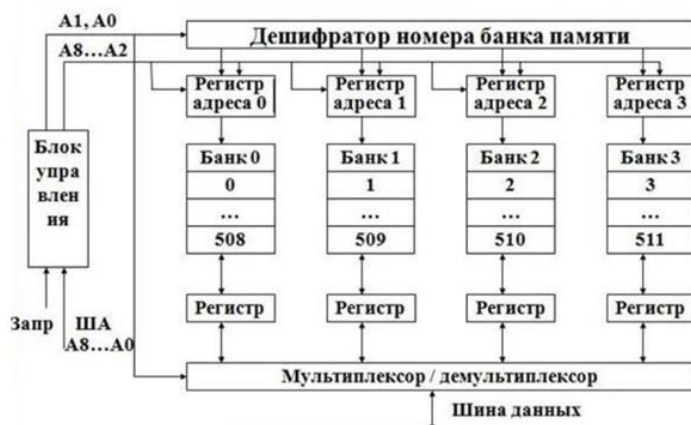
Рисунок 2.3.13 – расслоение памяти по четырем банкам.
